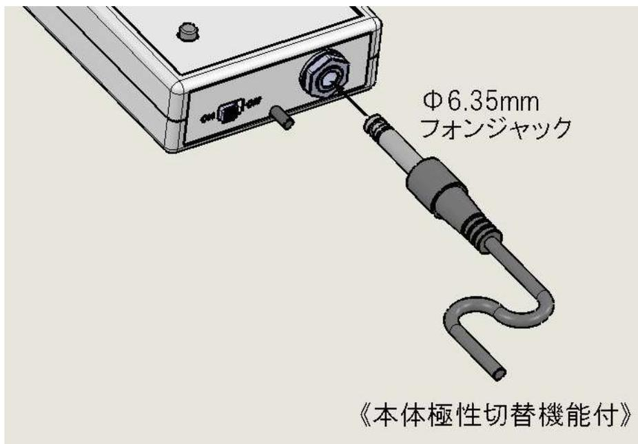
※フットスイッチ接続後もコントローラ側の操作ボタンを併用して使用することが可能です。フットスイッチを操作ボタンの代用として使うことも出来ます。
